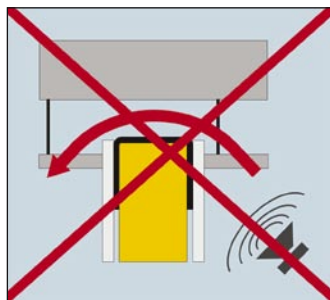
Pravilna in nepravilna izvedba detajla montažne stene in spušenega stropa
